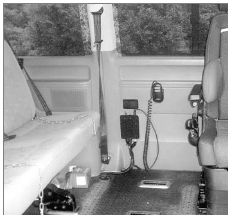
S el. vozíkem parkuji mezi sedadly zády ke stěně (řetězy s karabinou na koncích pro ukotvení leží na sedadle vlevo)
